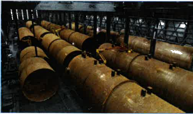
Fabricación de Tanques de almacenamiento de CO2 en nuestros talleres de Avilés
