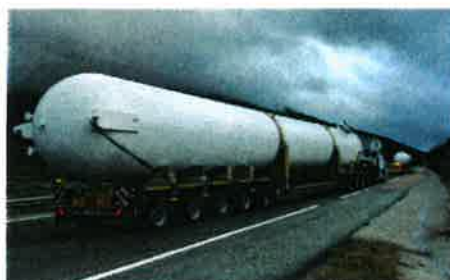
5 Tanques H2- 133 m3 cada uno Presión 60 bar
